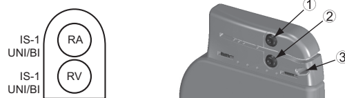
Figure 3. Connexions des sondes et emplacement des vis de fixation, RA : IS-1, RV : IS-1
