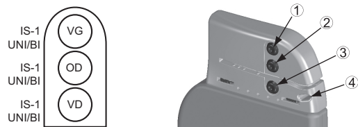
Figure 2. Connexions des sondes et emplacement des vis de fixation, OD : IS-1, VD : IS-1, VG : IS-1
