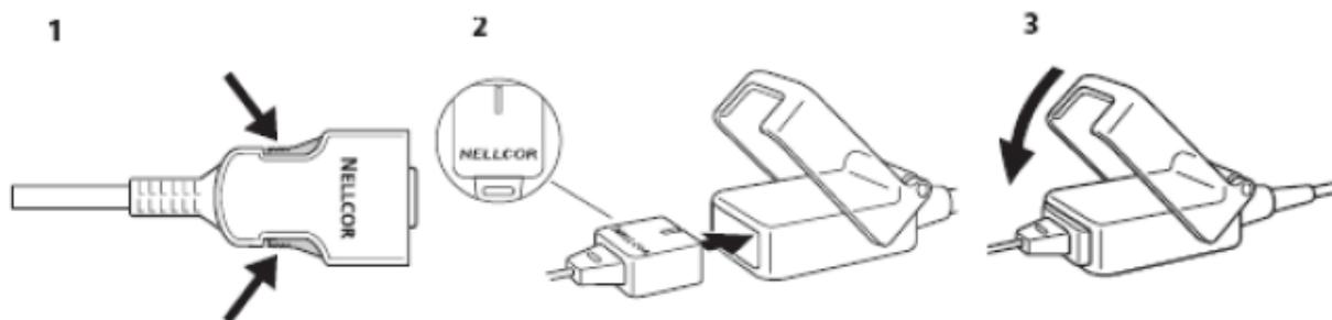
**Il faut utiliser uniquement des capteurs d'oxygène NELLCOR équipés de logement sur une face de la fiche de contact. Lors de la connexion du capteur sur le câble, toujours orienter la prise du capteur afin que NELLCOR soit visible.**
