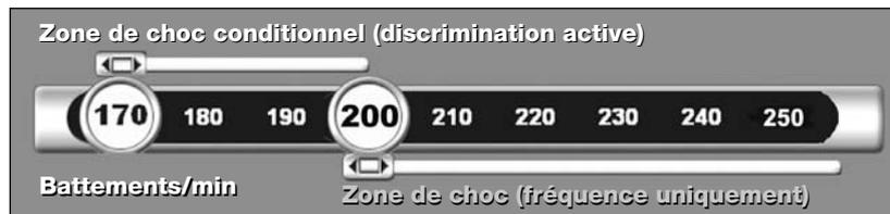
Figure 6 : Schéma de détection de fréquence des zones de choc
