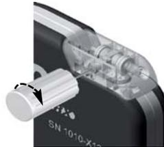
Figure 17 : Utilisation de la clé dynamométrique pour serrer la vis d'arrêt
