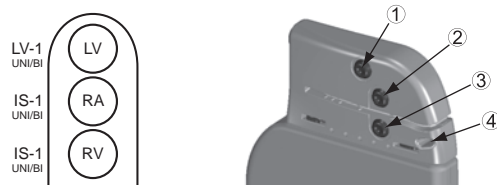
Figure 3. Connexions des sondes et emplacement des vis de fixation, RA : IS-1, RV : IS-1, LV : LV-1
