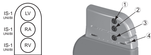
Figure 2. Connexions des sondes et emplacement des vis de fixation, RA : IS-1, RV : IS-1, LV : IS-1
