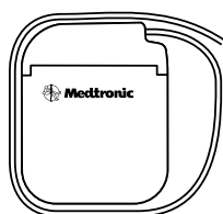
Figura 3. Enrole o excesso de extensões ou eléctrodos em redor do perímetro (ou por detrás) do neuroestimulador
