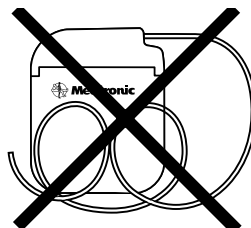
Figura 3. Enrole o excesso de extensões ou eléctrodos em redor do perímetro (ou por detrás) do neuroestimulador
