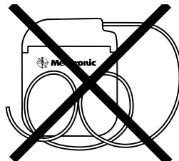
Εικόνα 3. Τύλιγμα των υπερβάλλοντων προεκτάσεων ή ηλεκτροδίων γύρω από την περίμετρο (ή πίσω) από το νευροδιεγέρτη.
