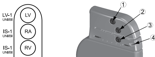
Figure 5. Connexions des sondes et emplacement des vis de fixation, RA : IS-1, RV : IS-1, LV : IS-1
