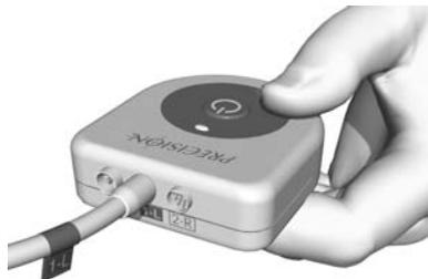
Les sondes supérieures (en haut ou à gauche) se connectent au port « 1-L ». Les sondes inférieures (en bas ou à droite) se connectent au port « 2-R ». Si une seule sonde est utilisée, connectez-la sur « 1-L ».
