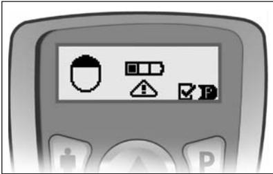
Si la batterie n'est pas rechargée, la stimulation s'arrêtera dans les 24 heures et le message suivant apparaîtra sur la télécommande : « Recharger stimulateur maintenant ». Lorsque la stimulation est arrêtée, la communication avec le stimulateur est perdue et plusieurs sessions de rechargement pourront être requises. Le stimulateur ne communiquera plus avec la télécommande tant qu'un niveau de chargement suffisant n'aura pas été atteint.
