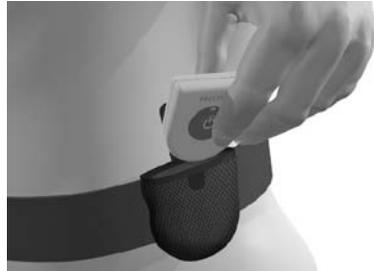
**Remarque :** si vous placez par mégarde le patch au mauvais endroit, ou si la ceinture se déplace, le chargeur recommencera à émettre un bip. Utilisez un nouveau patch adhésif ou réajustez la ceinture pour repositionner le chargeur.
