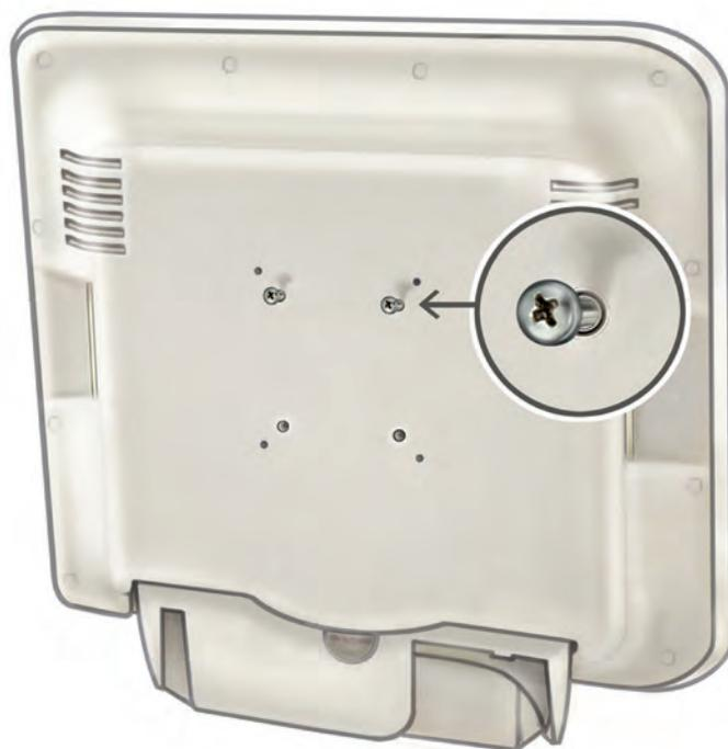
6. Demander à un assistant de soulever l'ordinateur à écran tactile en utilisant les poignées moulées des deux côtés de l'ordinateur, et glisser les deux vis de montage M4 x 10 mm sur l'ordinateur à écran tactile dans les deux fentes supérieures de la plaque de montage. L'assistant doit maintenir l'ordinateur à écran tactile dans cette position.
