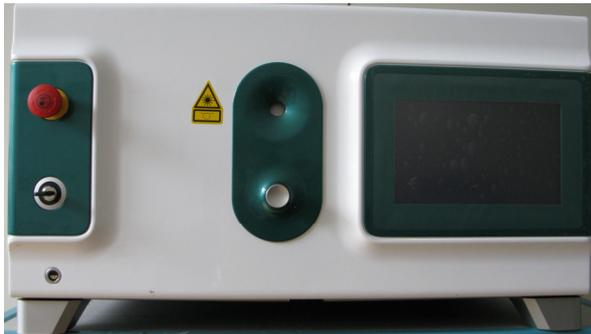
Fig. 6 : Signes à l'avant du système laser **Auriga Qi**®
