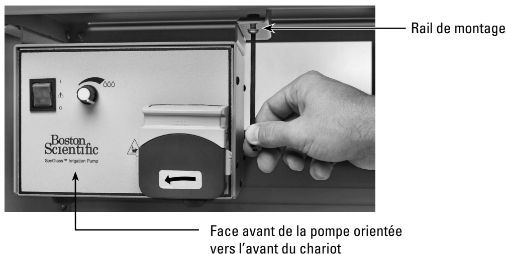
Figure 10. Remontage du support de pompe avec la pompe sur le chariot
