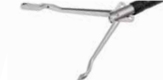
Babcock traditionnel modifié Configuration traditionnelle avec plaquettes de saisie plus larges pour permettre une prise plus sûre, plus douce des tissus délicats. Réutilisable REF 3271 Jetable REF 3272
