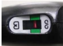
12. Prima dell'azione controllare quanto segue: La linea rossa è nel mezzo della striscia verde. La testina è attaccata fermamente. Per azionare lo strumento tirare indietro la sicura nella direzione della manopola, fino a che non sia collocata nel corpo dello strumento.
