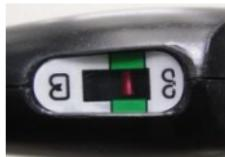
. 12 **Checkliste forud for affyringen:** Den røde streg er i midten af den grønne linie. Staplerhovedet skal være sikkert sat fast. For at affyre instrumentet, træk den røde sikkerhedsknap tilbage mod vingemøtrikken indtil den sidder i kroppen af instrumentet.
