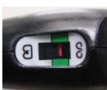
12. Lista de comprobación previa a la activación: La línea roja está en la zona media de la barra verde. El yunque está bien conectado. Para activar el instrumento, tire del bloqueo de seguridad rojo hacia la tuerca de mariposa hasta que se asiente en el cuerpo del instrumento.
