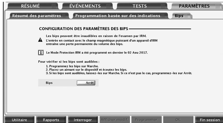
Figure 2-12. Ecran de configuration des paramètres du bipeur
