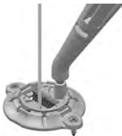
Figure 20. Positionner le clip de rétention au-dessus de la base
