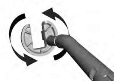
Figure 18. Sens de rotation pour l'extrémité en fer à cheval
