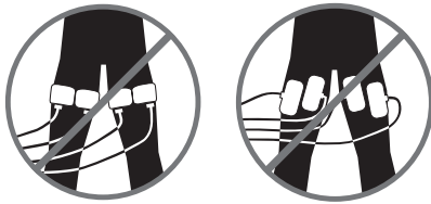
Figure 3 : Orientation et alignement incorrects des bords supérieurs
