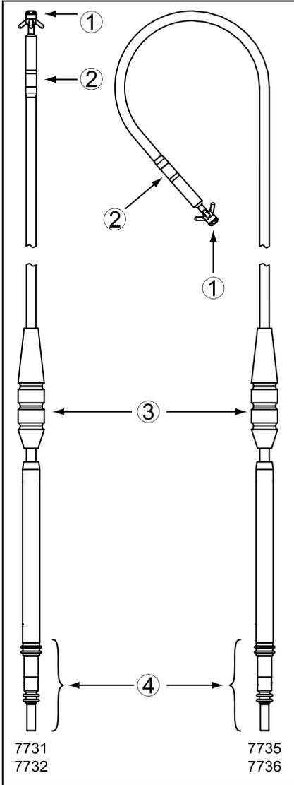
Fixation à barbes, corps de sonde de diamètre uniforme
