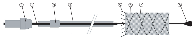
Abb. 2: Abgelöstes Einführsystem und entfaltetes p64-Implantat
