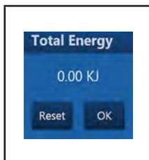
9. **Total Energy Indicator** (Indicateur d'énergie totale) : cet indicateur affiche l'énergie laser totale appliquée au site chirurgical pendant la procédure de traitement, étalonnée en kilojoules.
