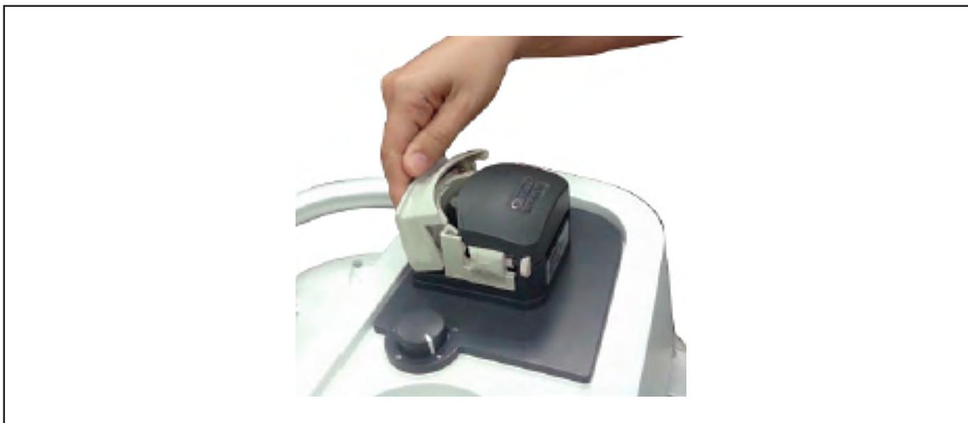
**Figure 14 : Tirer pour ouvrir la pompe d'aspiration**
