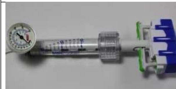
Image 3 : Représentation de la seringue avec dispositif de gonflage basixTOUCH.
