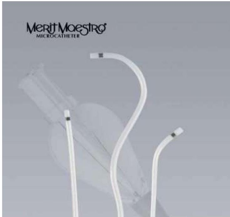
L'extrémité proximale du cathéter est constituée d'une embase moulée à ailettes avec soulagement de traction souple effilé relié à l'embase par l'intermédiaire d'une gaine encliquetable. L'embase à ailettes intègre un connecteur luer femelle répondant à la norme ISO 594-2:1998, et testé avec un calibre d'épaisseur luer mâle certifié conforme à la norme ISO 594-1:1996.
