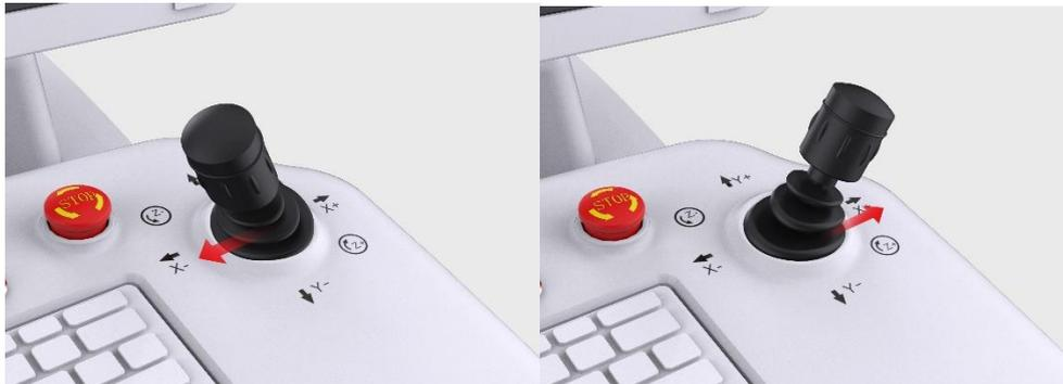
Figure 3. 3 Contrôle du mouvement de l'axe X du bras robotique
