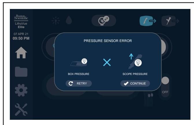
Figure 39. Écran de la console – message d'erreur de vérification du capteur de pression (pression trop élevée au niveau de l'urétroscope)
