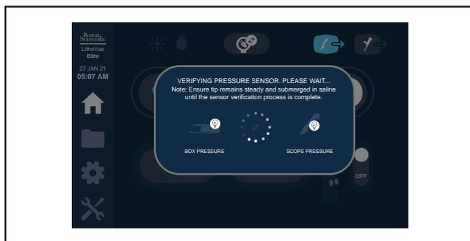
Figure 35. Écran de la console – vérification du capteur de pression
