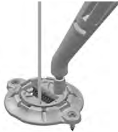
Figure 21. Positionner le clip de rétention au-dessus de la base
