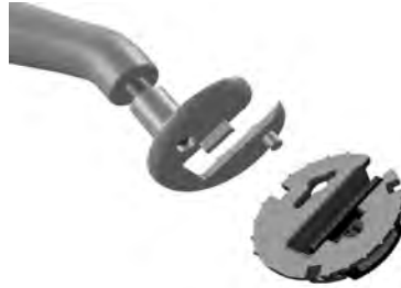
Figure 20. Fixer le clip de rétention à l'extrémité en fer à cheval de l'outil
