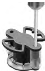
Figure 8. Base fixée à l'outil de préhension papillon avec un tournevis inséré
