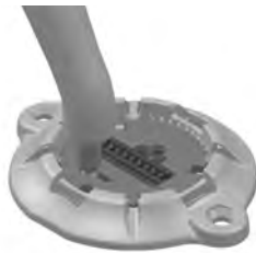
Figure 51. Insertion de l'outil de positionnement/retrait
