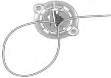
Figure 24. Positionnement de la sonde DBS dans des fentes de sortie de sonde supplémentaires
