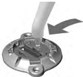
Figure 22. Verrouiller la glissière
